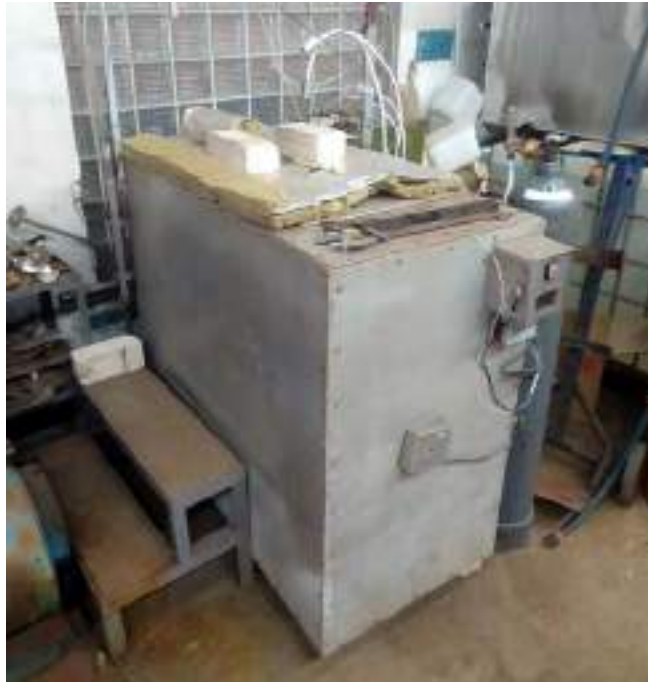
Рисунок 2.1. Лабораторний полімеризатор для виготовлення експериментальних зразків сцинтиляторів.
