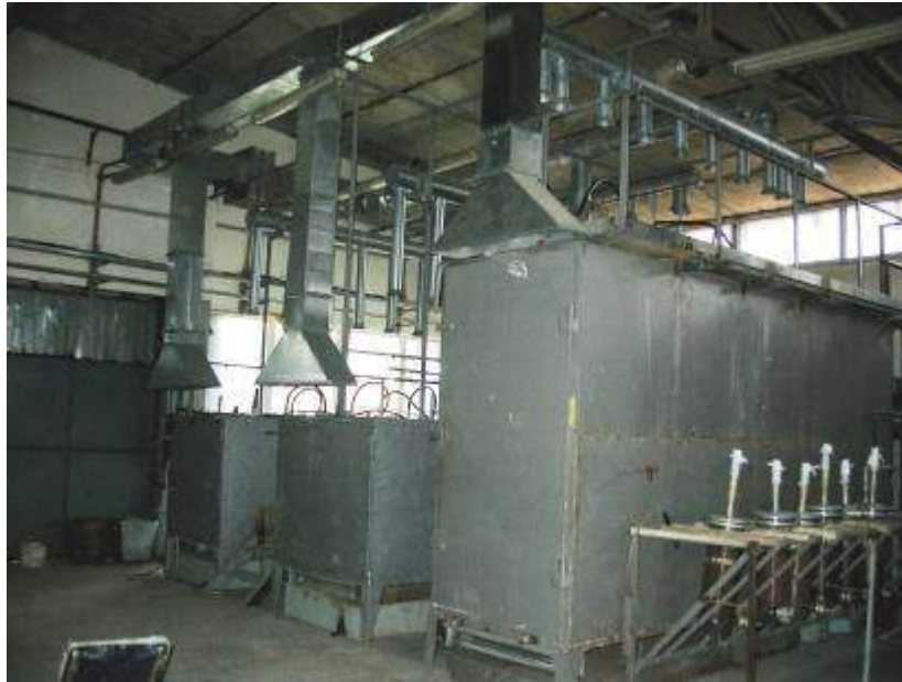
Рисунок 2.2. Полімеризатор для виготовлення пластмасових сцинтиляторів методом полімеризації в масі.
