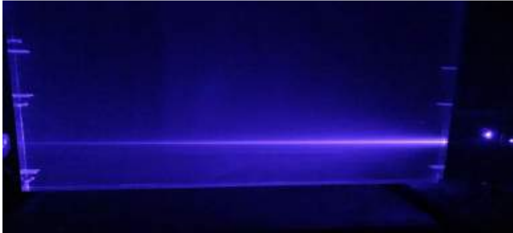
Рисунок 3.15. Промінь лазера, який проходить скрізь сцинтилятор без оптичних дефектів у вигляді свілей.
