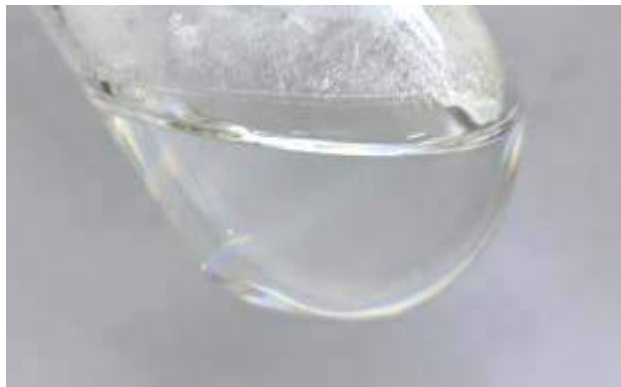
Рисунок 4.13. Зовнішній вигляд плаву n -Терфенілу після додаткової перекристалізації з трихлоретилену.
