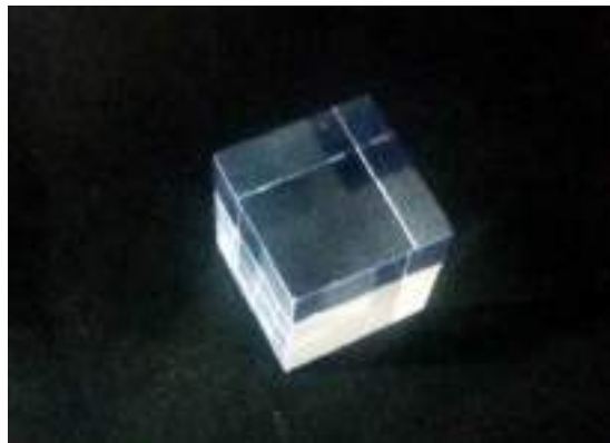
Рисунок 4.17. Сцинтилятор розміром 10 \times 10 \times 10 мм для тестування однорідності.
