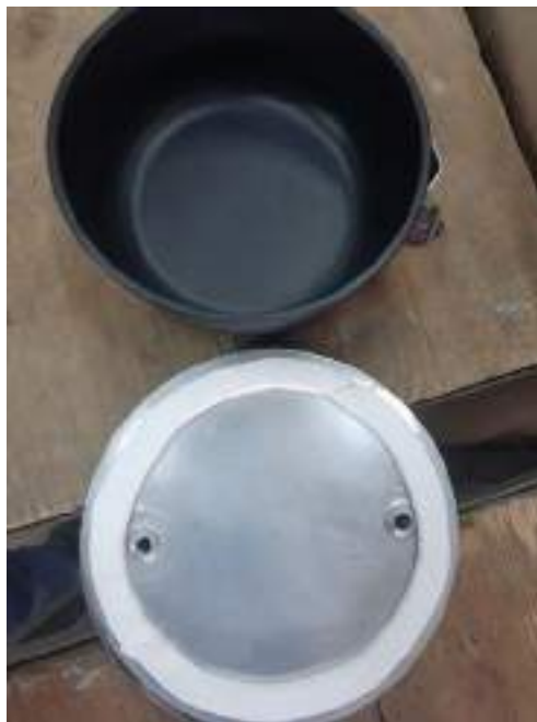
Рисунок 5.4. Виготовлена форма для полімеризації з кришкою.
