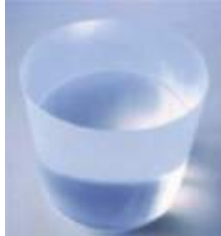
Рисунок 5.8. Фото зразка нейтрончутливого ПС діаметром 100 мм і висотою 110 мм
