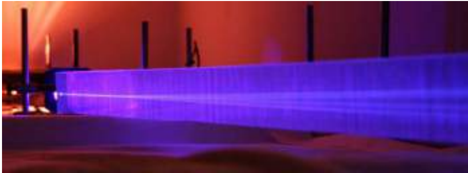
Рисунок 3.1. Зміна напрямку променя лазера в об'ємі сцинтилятора.
