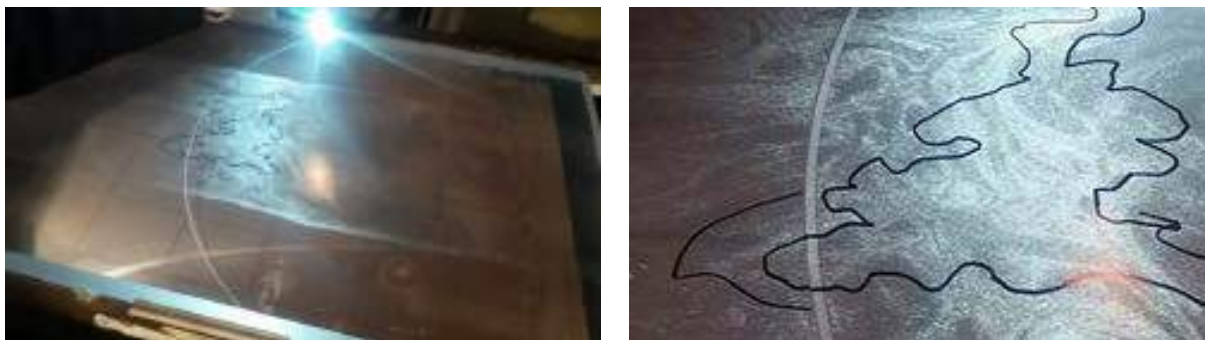
Рисунок 5.1. «Сріблення» поверхні пластмасового сцинтилятора.
