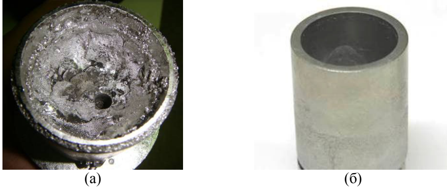
Рис. 1. Вигляд Мо тиглю після нагрівання у тепловому вузлі з теплоізоляцією : а) з діоксиду цирконію; б) з графіту.
