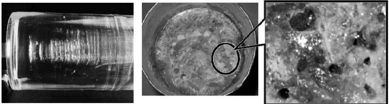
Рисунок 4. Розсіяння світла на газових включеннях (ліворуч) в кристалі BGO і газові порожнини в залишках сировини BGO в тиглі (праворуч) після вирощування.
